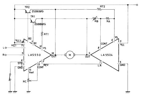
$R_A \!\!=\!\! 2.2 k\Omega$  $R_C$ =50 $k\Omega$ ,  $V_R$  $R_C=30k\Omega$ ,  $V_R$
