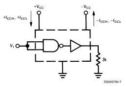
FIGURE 5.  $I_{CCH+}$ ,  $I_{CCH-}$ ,  $I_{CCL+}$ ,  $I_{CCL-}$
