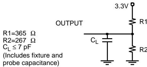
(a) LVTTL AC Test Load <sup>[7]</sup>
