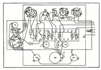
Fig. 9. Input section wiring diagram.
